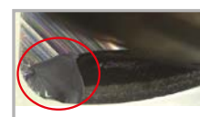
Poškození kvůli slabému břítu
